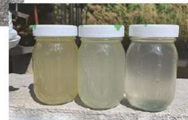
原水・オゾン反応タンク・生物処理タンク
