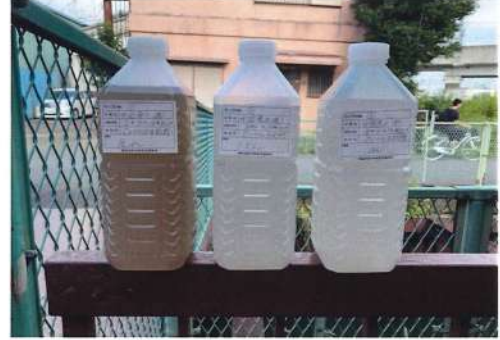
▶当社で行ったテストの処理水 脱色推移 (左)原水 (中央)オゾンマイクロバブル処理1.5h後 (右)オゾンマイクロバブル処理3.0h後
