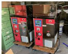
オゾン発生装置
