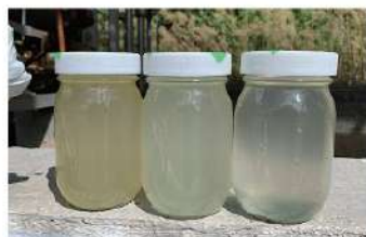
原水 O3+MB処理 生物処理
