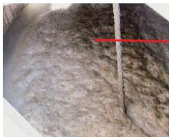
オゾン+マイクロ・ナノバブル 反応槽内部
